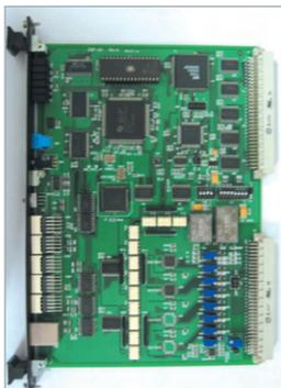
АОМ используется для регулирования увеличения или уменьшения выходной мощности генератора электростанции. Управление выводом осуществляется за счет Analog значений (Set Point), комбинируется с установкой управления электростанции (DCS) и сохраняет текущие показатели до последующей команды, сохраняет текущие показатели даже при потере питания RTU. Модуль вывода Set Point отображает полученные от центрального устройства данные в десятичном разряде и выводит сигналы управления и сигнализации.
