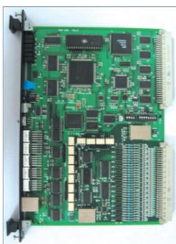
AIM преобразует аналоговые сигналы (напряжение, ток, активная/реактивная мощность, частота и т.д.), полученные от энергоустановки в цифровые и передает их на MPD, ввод поддерживается на устройстве преобразования.
