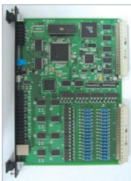
ПИМ используется при обработке импульсных данных, эти импульсные данные как данные, генерируемые импульсно на генерирующих установках обрабатываются с помощью схемы Optical Isolation как цифровые данные. Интегрированно сохраняет в цепи данные в преобразованном состоянии, в зависимости от сигнала команды EMS передает и обрабатывает данные.
