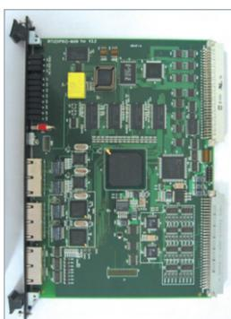
Плата CPU как основной модуль обработки FPD осуществляет связь с MPD, принимает модули с функцией I/O, отвечающие за ввод вывод на местах и управляет вводом выводом данных с Field. За счет использования IXP425 Microprocessor Intel доступна высокопроизводительная обработка, установлены 256Mbyte SDRAM, 512KB EPROM, 16MB Flash Memory, 8KB NVRAM/RTC, два 10/100 Ethernet Port и два Serial Port поэтому доступны различные Application.
