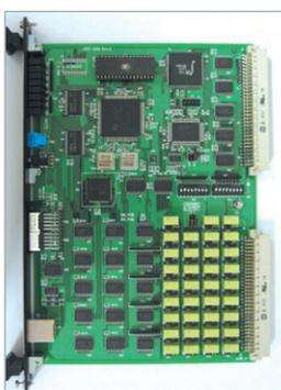
DOM приводится в действие при дистанционном управлении с верхних уровней HOST, вывод управления является импульсным сигналомиспользующим точку контакта Dry-Contact, применяется для активизации Trip/Close электричества наподобие переключателя, при выборе одновременно более 2 переключателей не действует.
