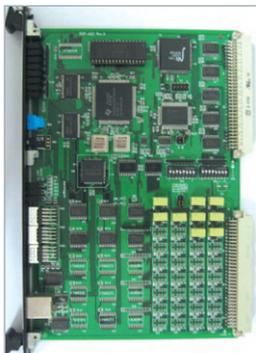
РОМ используется при автоматической передаче и выводе в виде сигнала, вычисленного по показателям понижения повышения вывода генератора с EMS, выводится в виде широтно-импульсного сигнала, использующего точку контакта, не применяет функцию проверки перед началом работы (Check Before Operation). Соединяется с последовательной цепью генератора, непосредственно осуществляет дистанционное управление генерированием.
