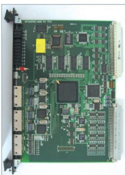
Плата SIO-B является платой VMEbus, разработанной с использованием IXP425 CPU IXP425 CPU высокоскоростного микропроцессора 32bit Интел.
